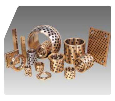
MBW-Gleitelemente bestehen aus einem Grundkörper aus hochverschleissfesten Kupferlegierungen (z.B. Bronze, Messing, Sondermessing usw.). In die Gleitflächen sind in regelmässigen Abständen Festschmierstoffdepots eingelassen. Die Verteilung dieser Depots ist dem Bewegungsablauf angepasst. Der stabile Bronzekörper kann hohe Belastungen aufnehmen, während eventuelle Schmutzpartikel in den Schmierstoffdepots eingelagert werden können.
